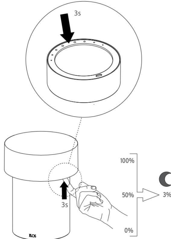
**IT** Fig.4 FUNZIONE "NIGHT SHIFT": Ad apparecchio acceso a qualsiasi livello d'intensità luminosa e ad apparecchio spento, una pressione continua del dito sul pulsante di almeno 3 secondi porta l'intensità luminosa direttamente al 3%.
