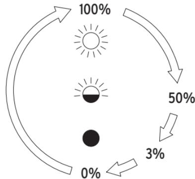
图3. 光学传感器。轻轻触碰压印在灯头下沿圆拱中心的光学传感器(S)，可依次激活以下功能：1-以100%强度开启；2-50%强度；3-3%强度；4-关闭电源。注意：受到阳光直射或较高的红外辐射水平（例如，距离卤素灯很近）可能暂时影响传感器的灵敏度。如有必要，可通过以下步骤，将本装置置于“休眠”模式（停用传感器）：1-连接电源线；2-将手指置于传感器(S)上；3-手指仍保持在传感器上，移除电源线；4-等待直至本装置关闭。
